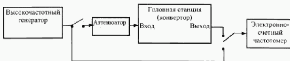
Рисунок 7.16 — Структурная схема для определения отклонения от номинального значения несущей частоты радиосигналов изображения и ОВЧ ЧМ вещания
