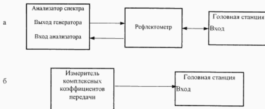
Рисунок 7.15 — Структурная схема для измерения затухания несогласованности
