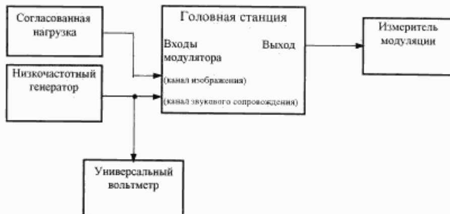
Рисунок 7.25 — Структурная схема для определения уровня мощности сигнала звукового сопровождения на входе модулятора и измерения девиации несущей частоты радиосигнала звукового сопровождения
