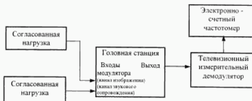
Рисунок 7.23 — Структурная схема для определения отклонения разности несущих частот радиосигналов изображения и звукового сопровождения от номинального значения
